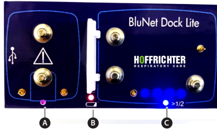
A Kontroll-LED DIB-Positionierung B LED BluNet-Ladestatus C LED Aufladen für eine Nacht Abbildung 14: BluNet Dock Lite - LED-Anzeige
