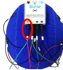
Abbildung 40: Verbindung der vorverkabelten Elektordern an den Eingang des Blu-Net EXG
