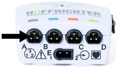
Abbildung 40: Verbindung der vorverkabelten Elektordern an den Eingang des Blu-Net EXG
