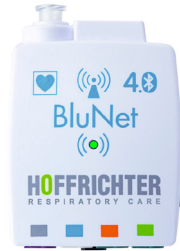
Abbildung 33: Grüne LED (1 Sekunde blinkend): aktives Gerät
